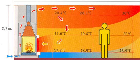
Диаграмма (слева) показывает распределение температур, зафиксированное в реальных комнатах с объемом 250 куб м с традиционной системой отопления.
